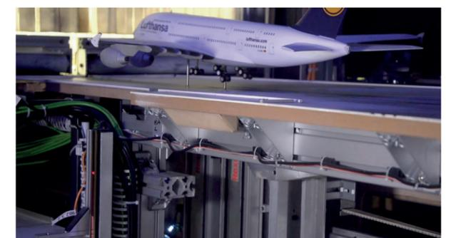
不同的高度进行。这些窗口以云幕掩盖。根据飞机当前的飞行高度，两个平行运行的线性轴集成组件可以对云幕进行非常精确地控制和调整。
